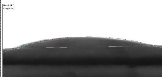
Figura 3. Ensayo del ángulo de contacto en membranas
