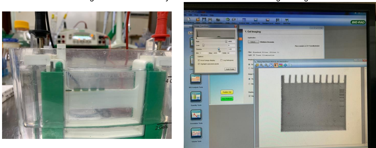
Figura 1. Electroforesis y visualización de bandas en el gel de agarosa
