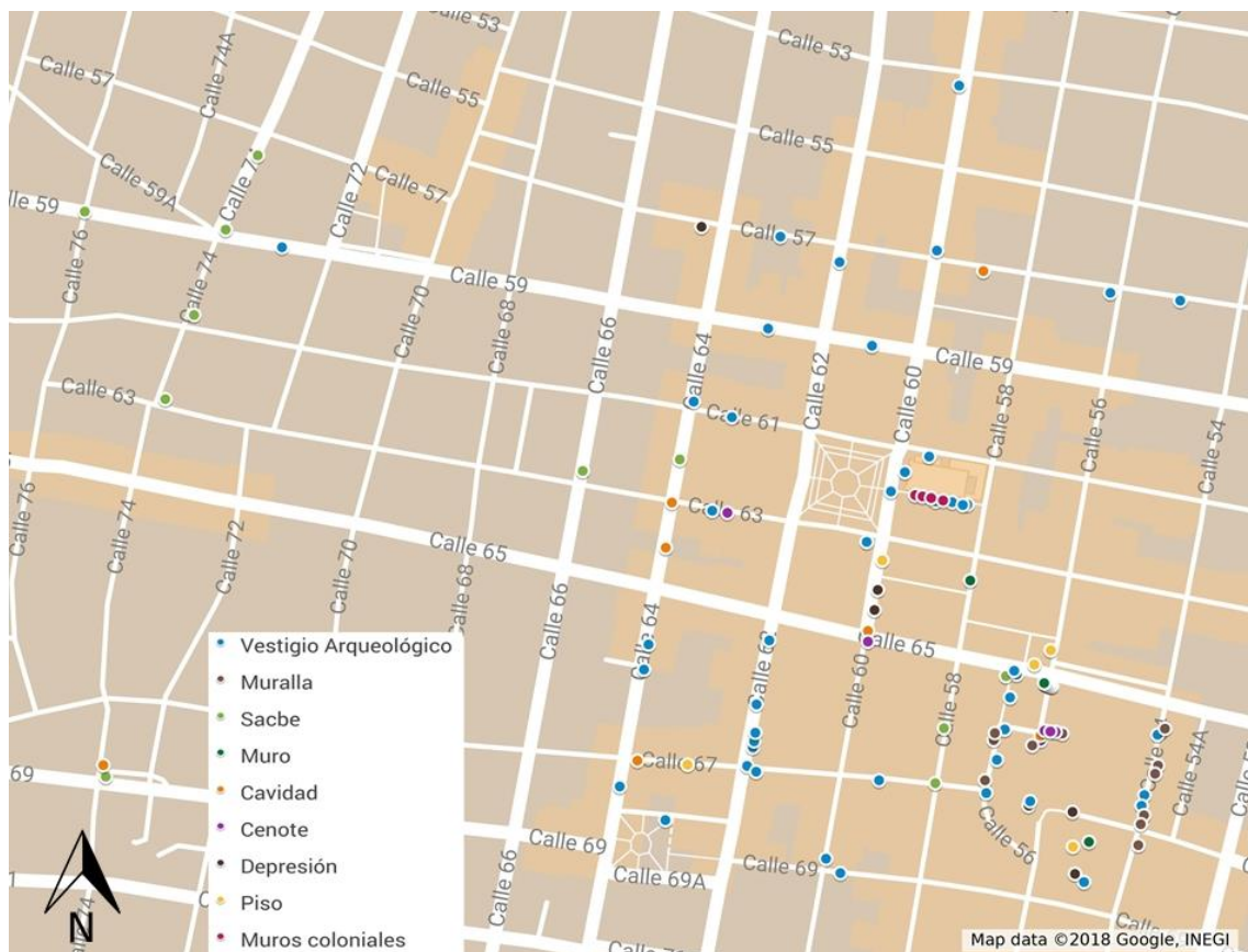
Figura 9: Mapa que muestra las anomalías detectadas con el georradar (GPR) y su interpretación (elaboración propia).
