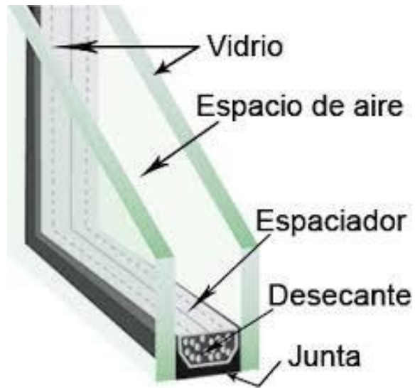
Figura 44: Perspectiva del sistema de doble acristamiento propuesto (fuente: Internet).
