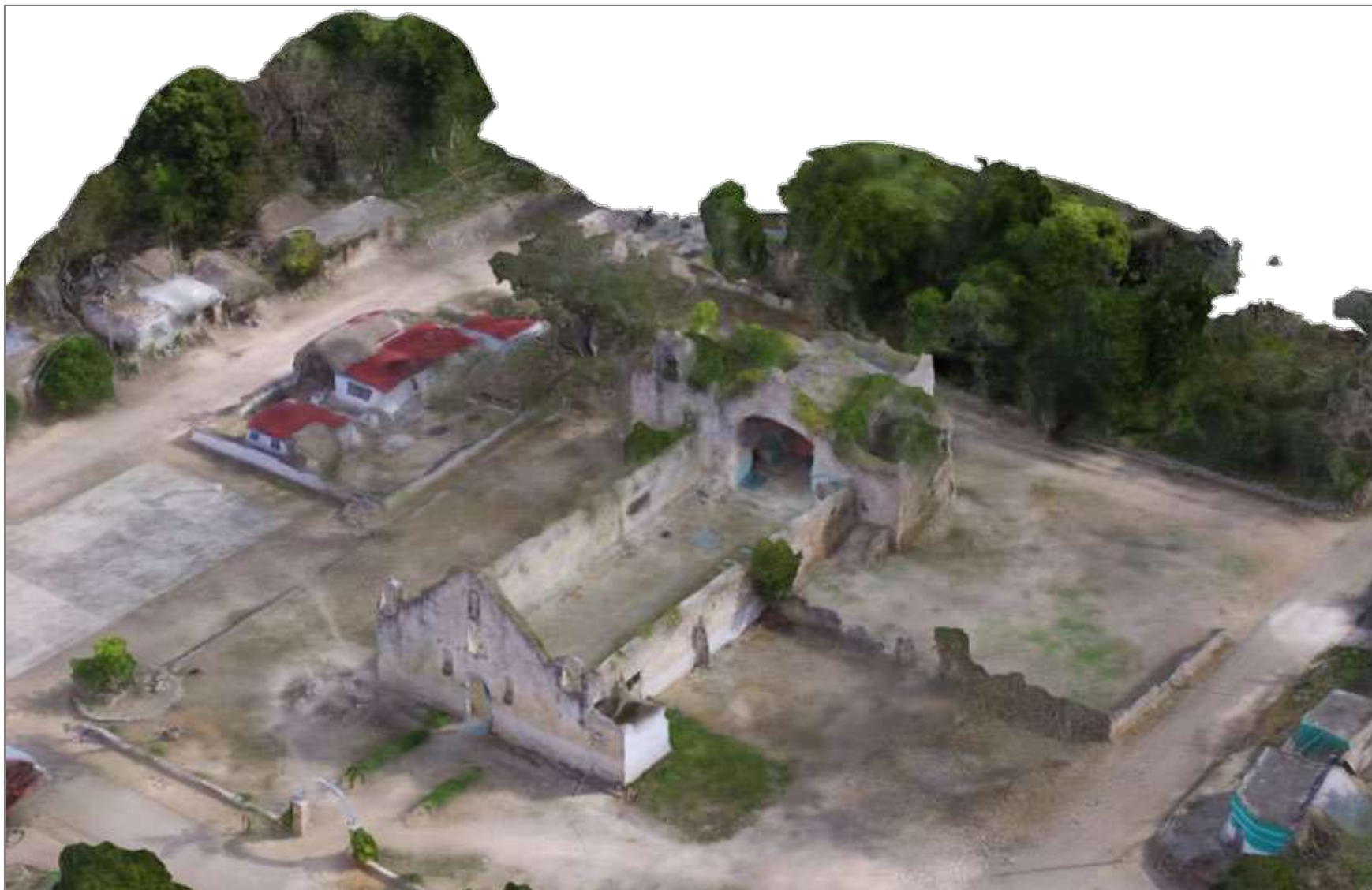
Figura 44. Maqueta tridimensional generado por nube de puntos. Elaboración: ArqueoDron®, enero 2018
