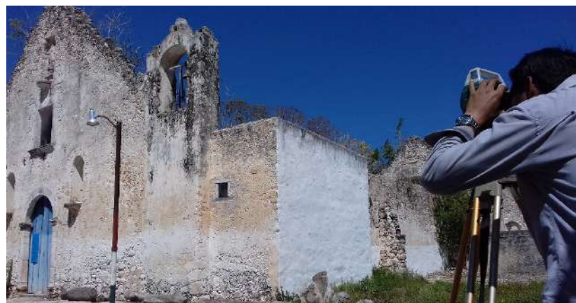
Foto 7411. Levantamiento realizado con estación total con el apoyo del Ing. David Hu de la Universidad Autónoma de Yucatán. Foto: LAR, abril 2018
