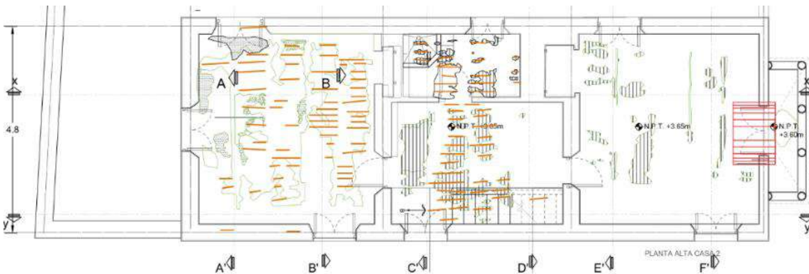
Ilustración 67. Plano de deterioros casa 2
