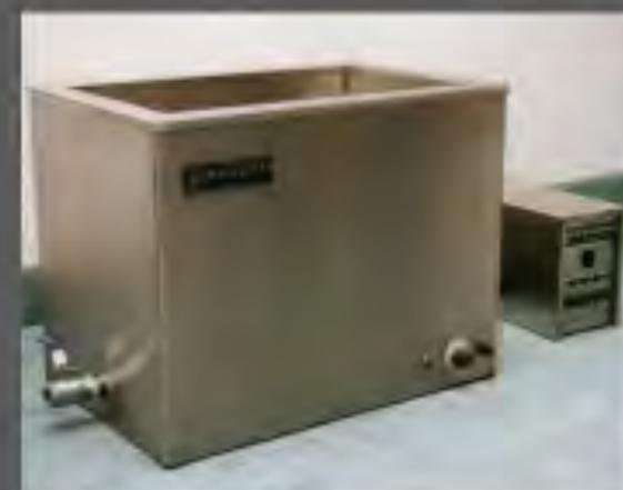
Consiste en la inmersión del objeto a limpiar en agua u otro líquido, aplicando ultrasonidos producidos por un aparato contenedor (limpiador ultrasónico). Estos ultrasonidos generan ondas de choque que progresivamente desestructuran y destruyen los depósitos que haya sobre la roca, tales como los carbonatos depositados sobre piezas de cerámica, y las costras negras presentes sobre pequeñas superficies de roca.
