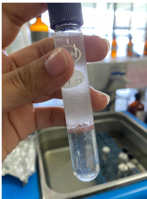
Figura 24: EVA en Tolueno en la parte superior y agua en la parte inferior
