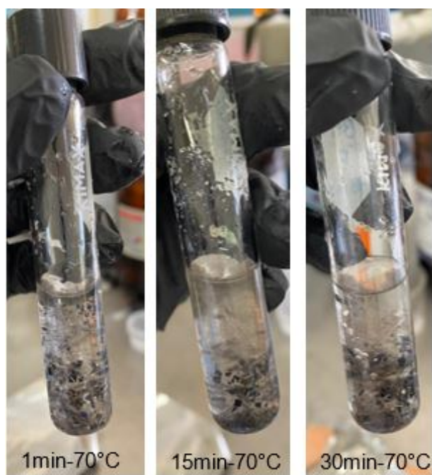
Figura 17: Muestras con benceno durante 1 min, 15 min y 30 min en baño maria a 70°C
