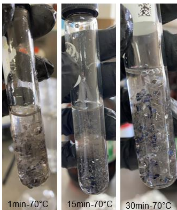
Figura 20: Muestras con Tolueno durante 1 min, 15 min y 30 min en baño maria a 70°C
