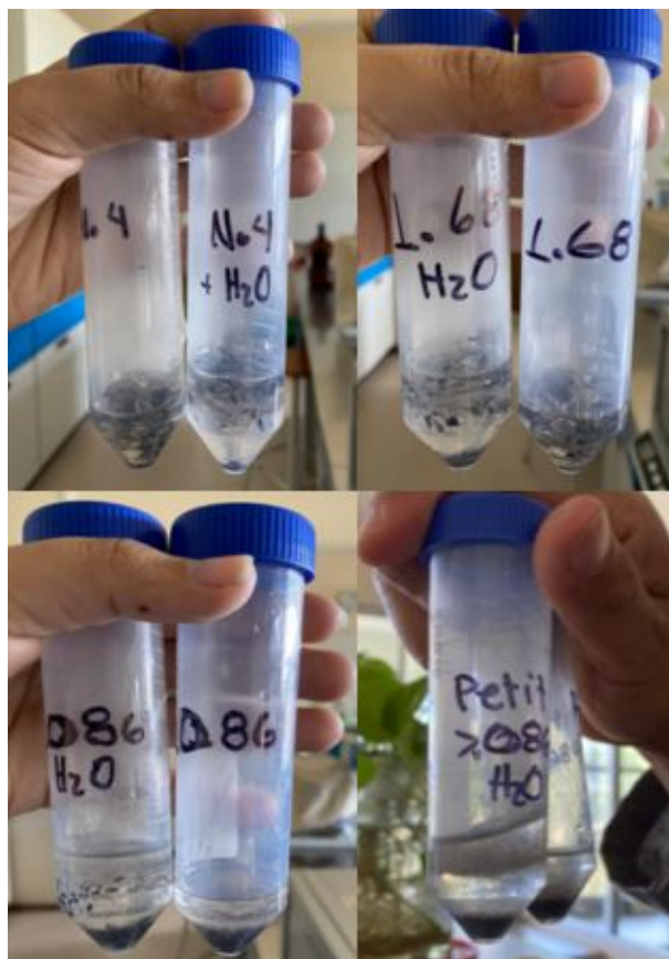
Figura 27: Muestras después de centrifugar, 4.4mm, 1.68mm, 0.086mm y menor a 0.086mm respectivamente
