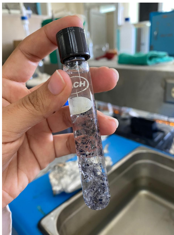
Figura 23: Muestra con Tolueno + agua (120 min, 70°C)
