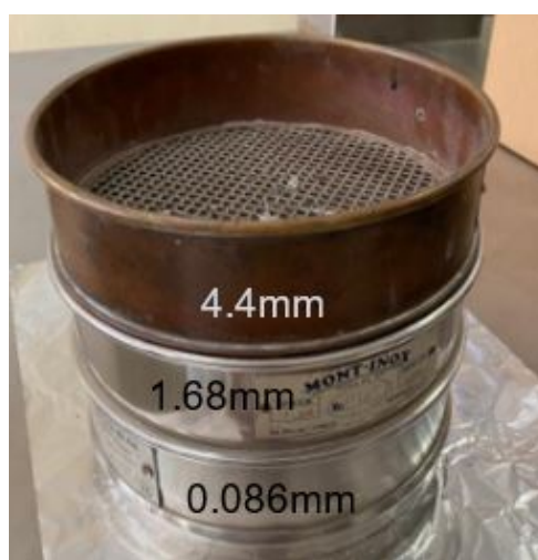
Figura 25: Tamices para separar muestras por tamaño
