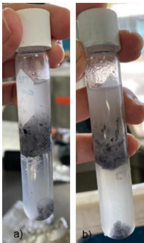
Figura 21: a) Tolueno+agua sin baño ultrasónico. b) Tolueno+agua después de 30 min en baño ultrasónico
