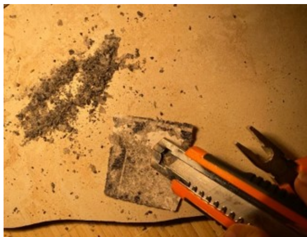
Figura 12: Desprendimiento de celda+EVA del backsheet
