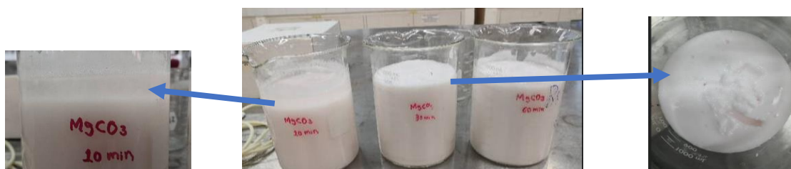
Figura 16. Mezclas bifásicas a la salida del reactor
