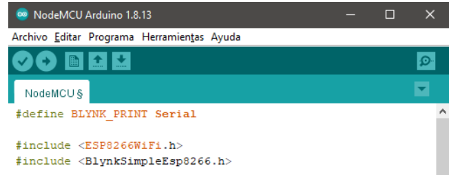
Figura 14. Librerías utilizadas en el sistema embebido NodeMCU ESP8266
