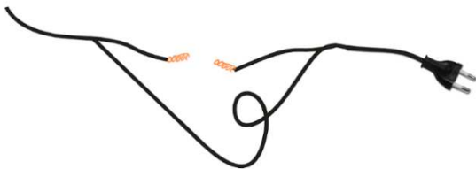
Figura. 7 Corte sobre uno de los cables del calentado
