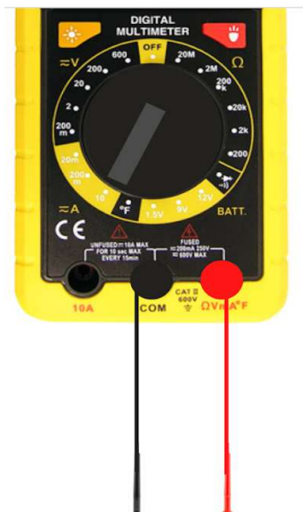
Figura. 12 Colocación de las terminales del multímetro
