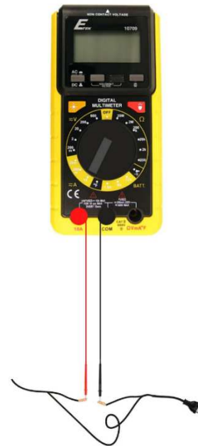
Figura. 10 Unión de las puntas a la resistencia eléctrica
