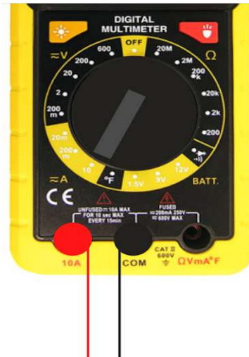
Figura. 9 Colocación de las terminales del multímetro
