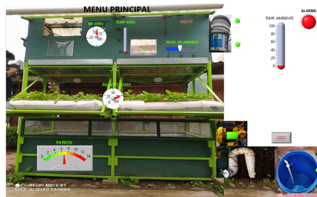
Figura 5. Sistema de monitoreo automatizado para el huerto vertical modular.
