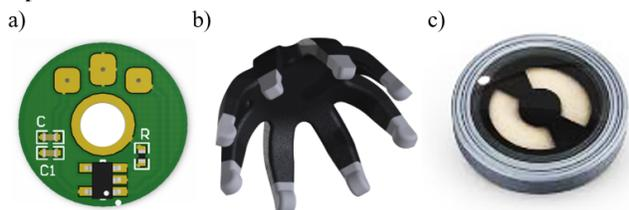
Figura 2: Electrodos para el registro de las señales: a) circuito activo, b) electrodo flexible de Cognionics para el registro de EEG, c) electrodo plano de Cognionics para el registro de EOG y EMG.
