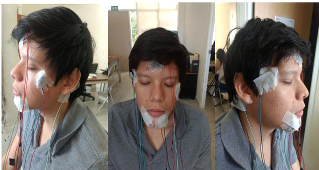
Figura 4: Montaje de los electrodos para el registro de EMG y EOG
