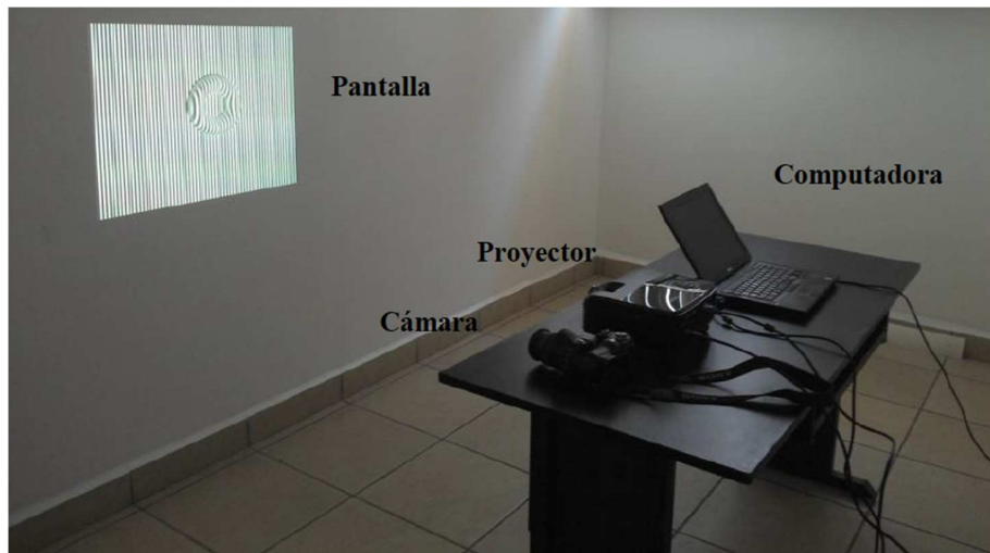
Figura 6. Fotografía del arreglo experimental compuesto por una pantalla plana blanca, una cámara fotográfica y un proyector.
