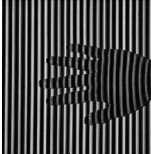
Figura 2. Deformación de las franjas de la rejilla proyectada sobre una mano humana debido al relieve del objeto.
