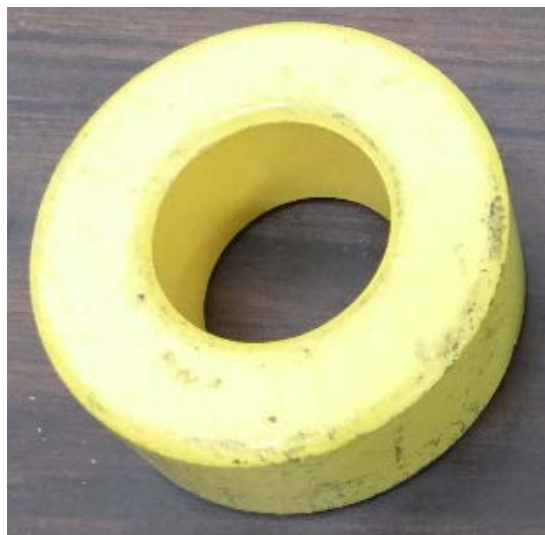
Figura 3.12. Núcleos para la elaboración de la bobina del boost.
