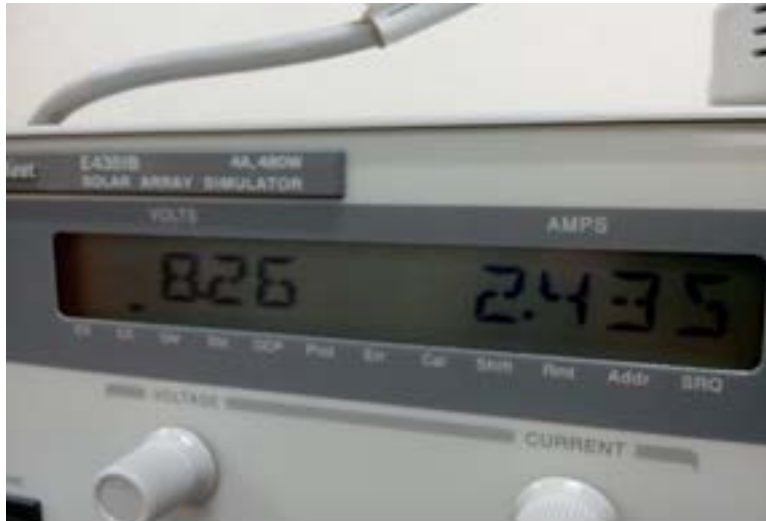
Figura 3.32. Display frontal del simulador de paneles fotovoltaicos Agilent E4351B.
