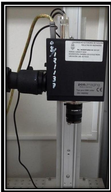
**Figura 3.7.** Cámara Digital Infrarroja de la FIUADY.
