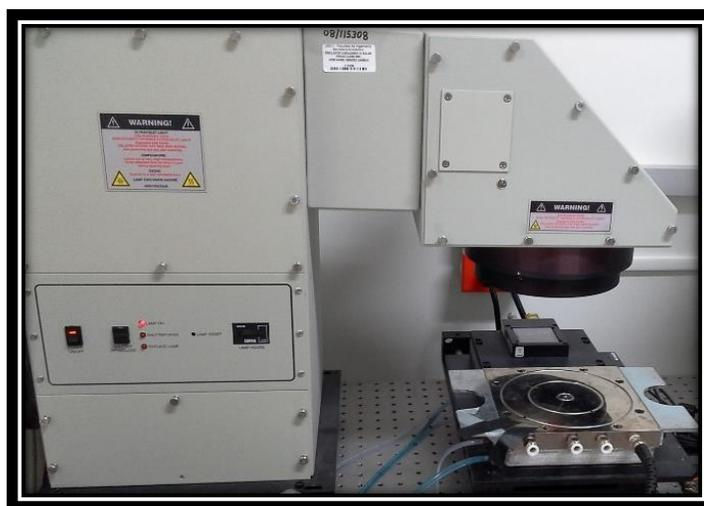
**Figura 3.5.** Simulador Solar de la FIUADY.
