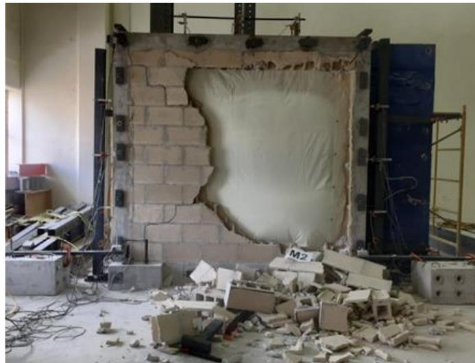
Figura 4.18. Falla del muro M2
