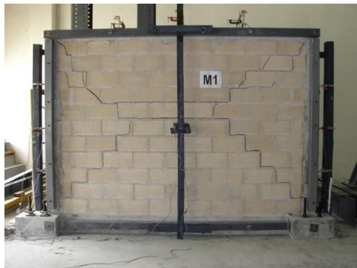
Figura 4.4. Patrón de agrietamiento del muro M1
