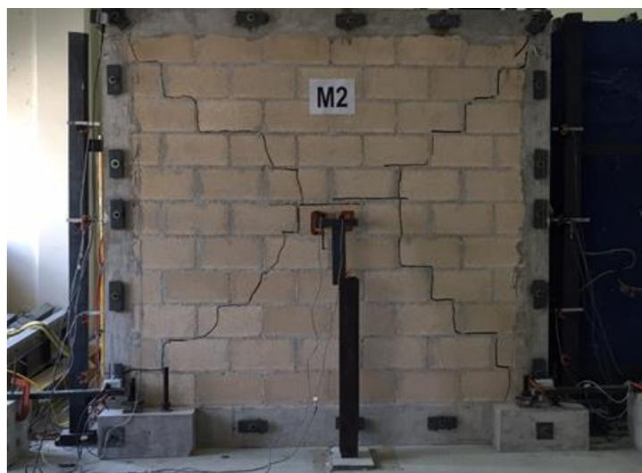
Figura 4.16. Patrón de agrietamiento del muro M2
