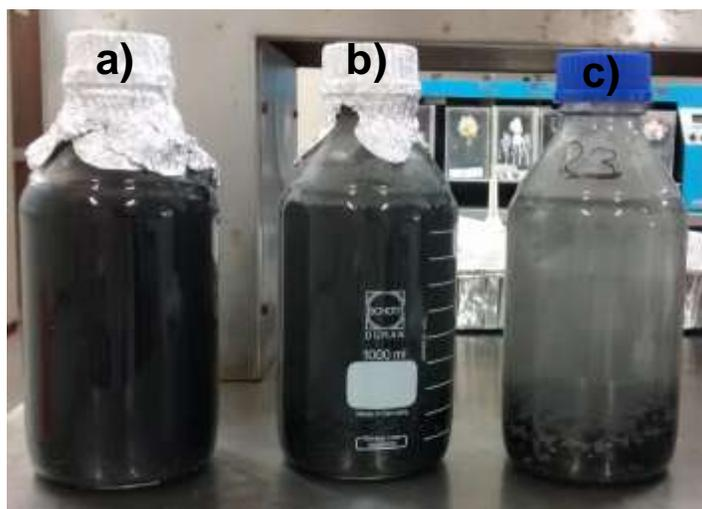
Figura 4.2 a) y b) Solución de agua de mar y fenantreno y carbón con inóculo, c) Solución sin inóculo
