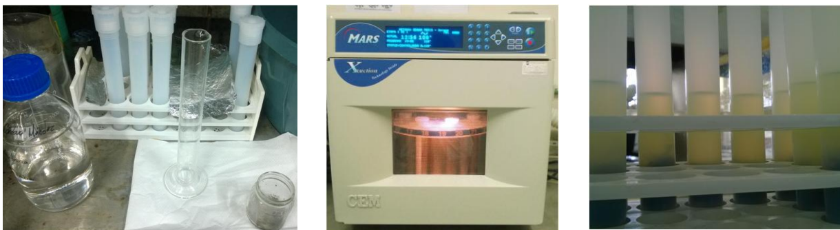
Figura 5. Preparación de las muestras para extracción por microondas
