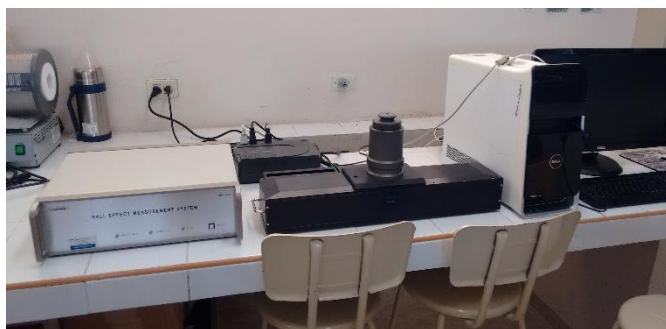
Figura 18. Equipo de Efecto Hall (Propiedades eléctricas)
