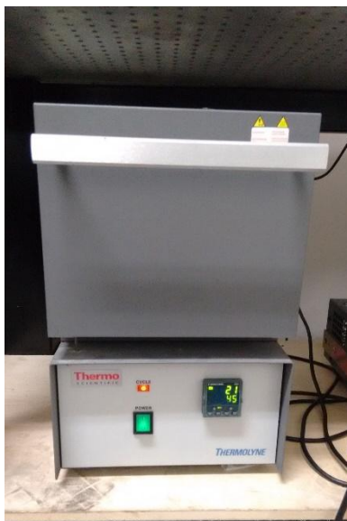
Figura 28. Tratamiento térmico en mufla programable
