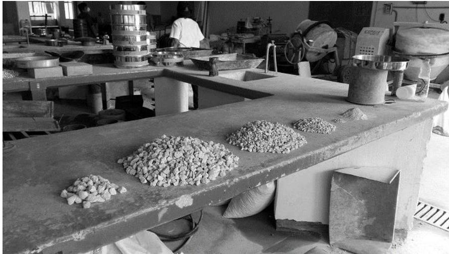
*Figura 3.1: Granulometría de agregados.*
