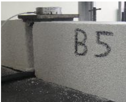
Figura 4.2 Falla típica observada en los bloques de CCA
