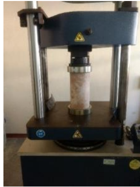
Figura 3.3 Vista del ensaye a compresión axial de un cilindro de concreto
