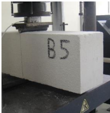
Figura 3.2 Vista del ensaye a tensión de un bloque de CCA
