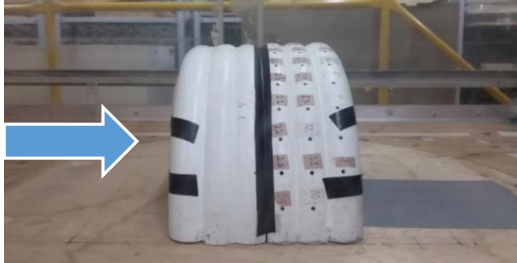
Figura 3.11. Prueba del modelo en configuración cerrada a 0°.
