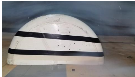
Figura 3.15. Embate del viento en el modelo durante el ensaye en configuración cerrada a 90^\circ .
