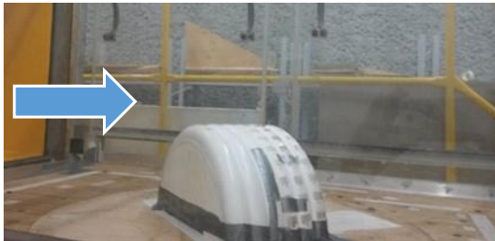
Figura 3.13. Prueba del modelo en configuración cerrada a 45°.
