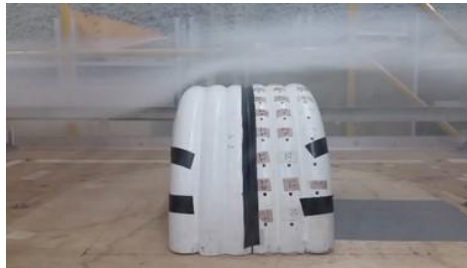
Figura 3.14. Embate del viento en el modelo durante el ensaye en configuración cerrada a 0^\circ .
