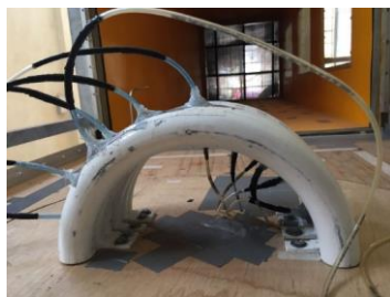
Figura 3.9. Modelo en configuración abierta instrumentado.
