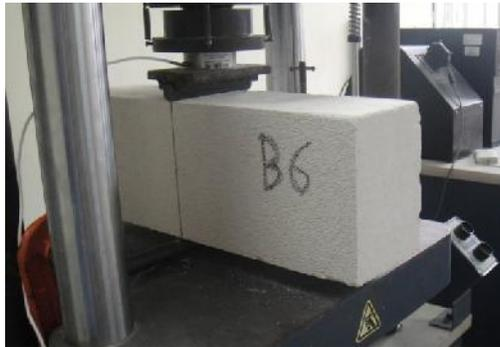
Figura 3.2 Vista del ensaye a tensión de un bloque de CCA
