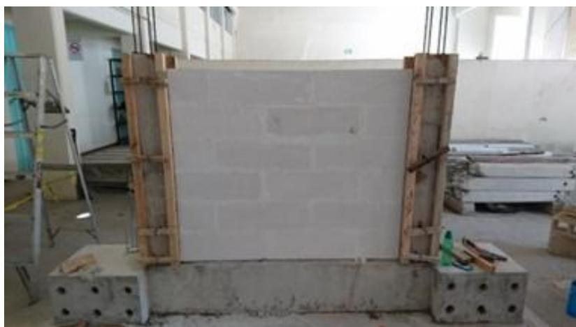
Figura 3.13 Primera media altura del muro
