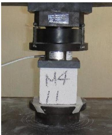
Figura 3.1 Vista del ensaye a compresión axial de un cubo de CCA
