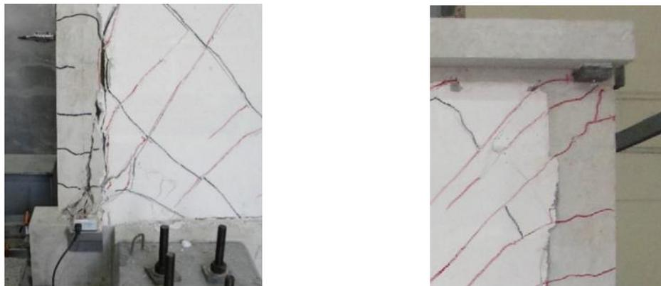
Figura 4.6 Grietas diagonales en la parte inferior y superior de los castillos del muro Mc1
