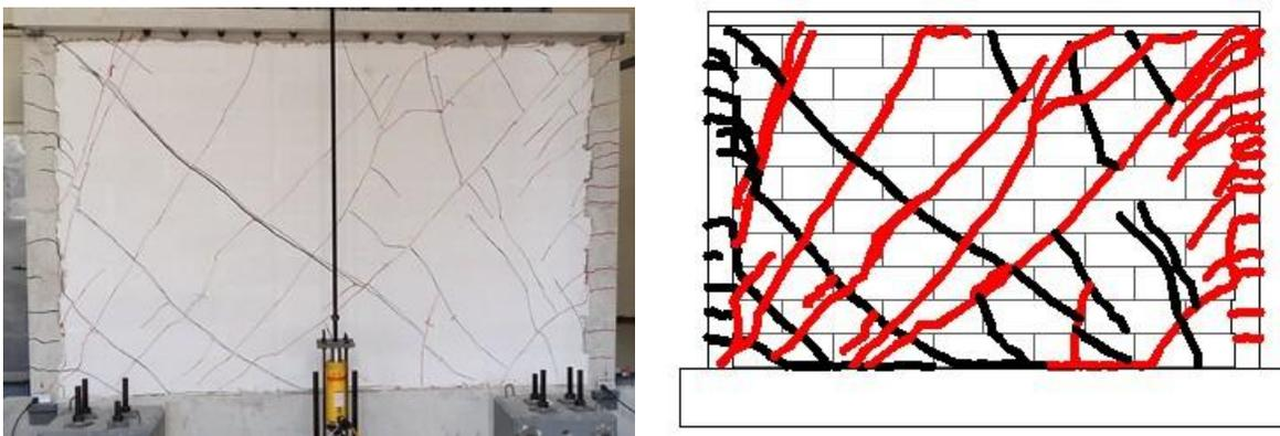
Figura 4.5 Grietas diagonales en la parte central y superior del muro Mc1
