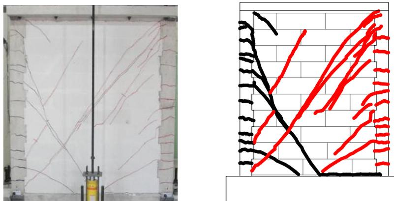
Figura 4.11 Agrietamiento diagonal en la parte central del muro Mc2
