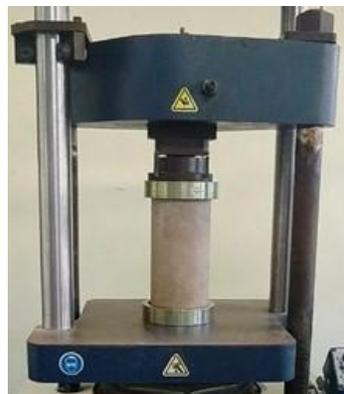
Figura 3.3 Vista del ensaye a compresión axial de un cilindro de concreto
