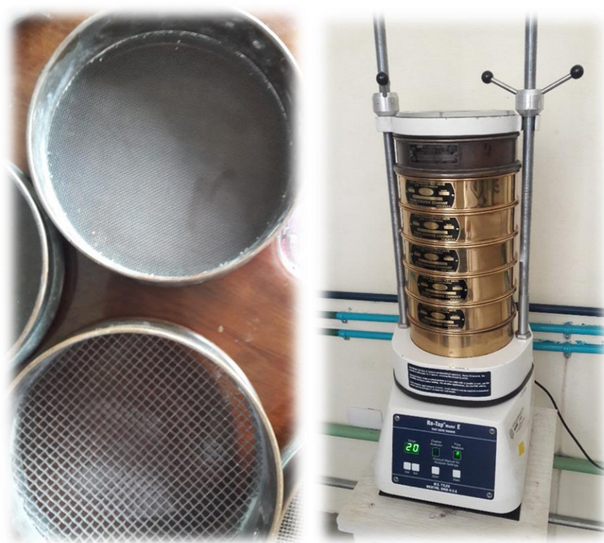
Figura 8. Trituración y tamizado del carbón vegetal
