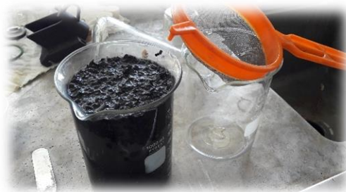
Figura 9. Tratamiento del carbón con HCl
