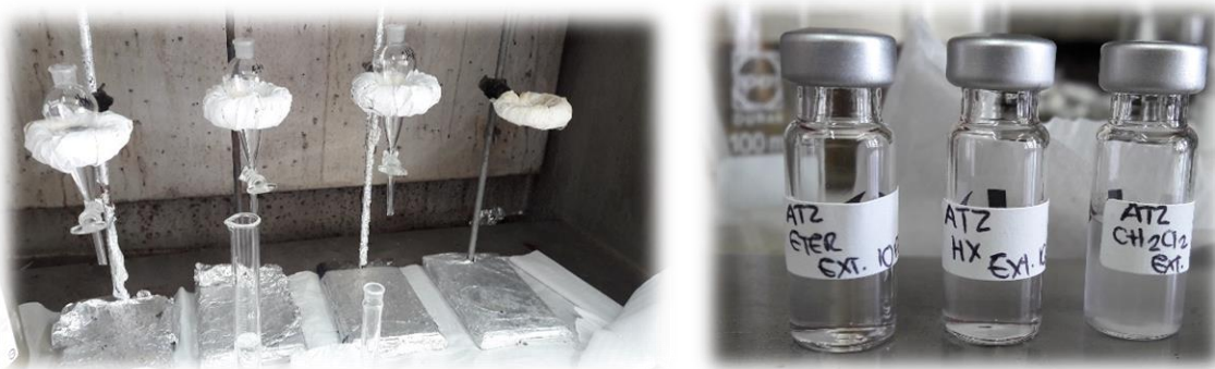
Figura 6. Extracción con Hexano, Éter y Diclorometano.
