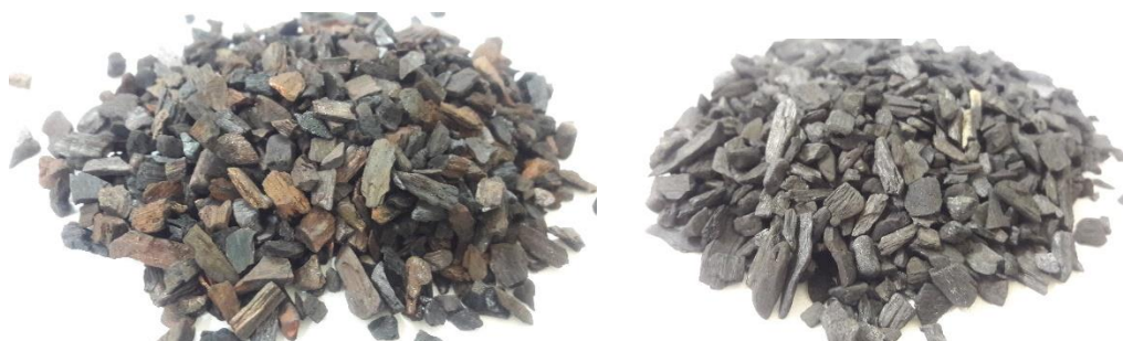
Figura 12. Lotes de carbón impregnados con \text{FeSO}_4 \cdot 7\text{H}_2\text{O}
