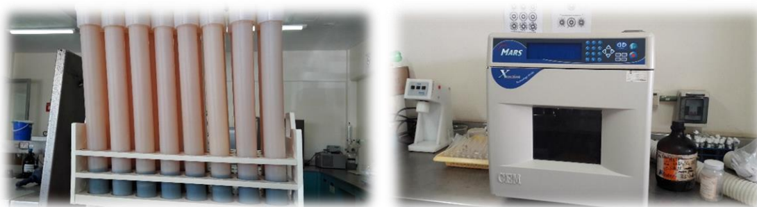
Figura 14. Tubos de teflón con muestra y equipo Mars
