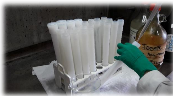
Figura 13. Preparación de muestras para absorción atómica
