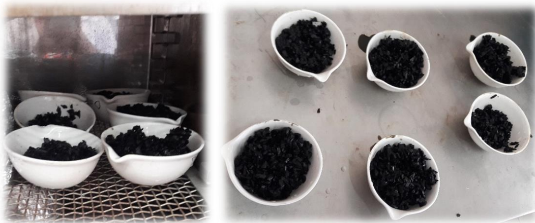
Figura 11. Secado y calcinación de carbón vegetal
