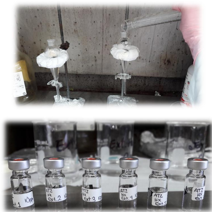
Figura 7. Extracción del plaguicida con Hexano
