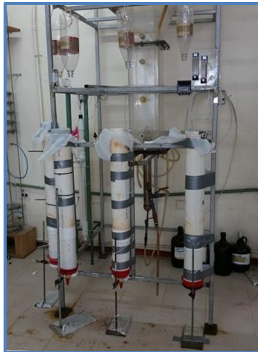
Figura 4.4 Armado de las columnas de suelo.
