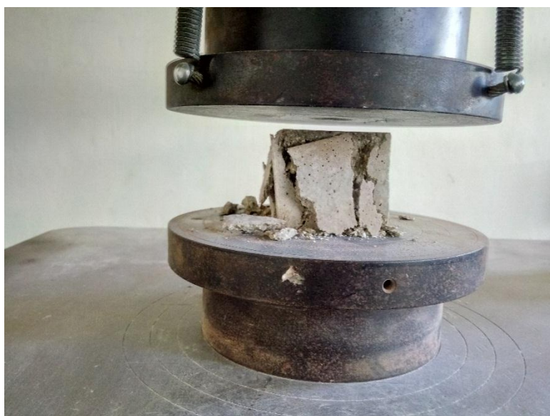
Figura 3.30 Prueba de resistencia a compresión axial de mortero 1:3
