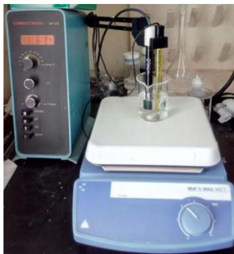
Figura 3.28 Determinación del contenido de cloruros libres en muestras de polvo con el equipo Conductronic
