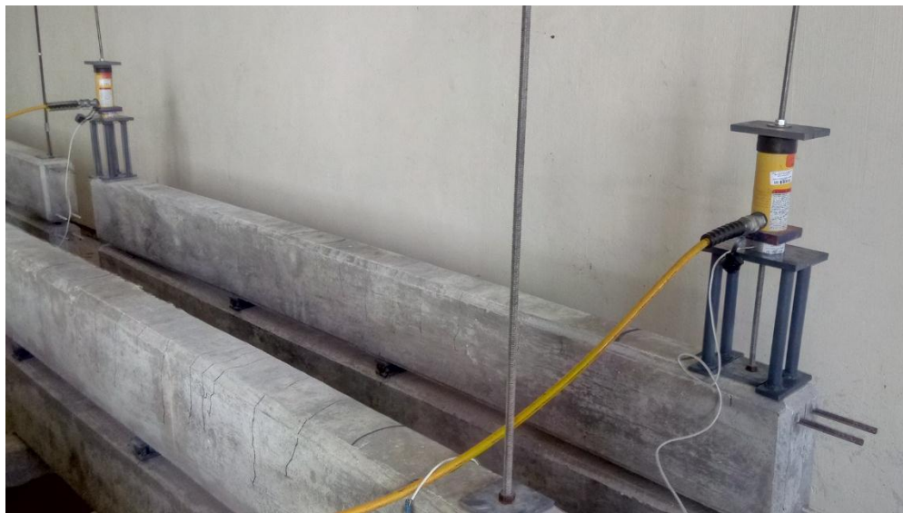
Figura 3.20 Colocación de sistema de postensado
