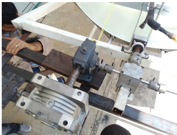
Figura 28. Sistema de seguimiento para el arreglo de colectores de canal parabólico.
