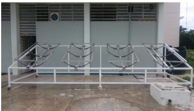
Figura 26. Arreglo de Colectores de Canal Parabólico, sin la superficie reflectante, tubos receptores, sensores y sistema de seguimiento.
