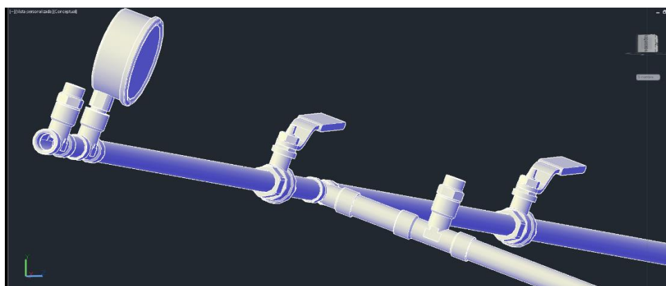
Figura 21. Vista de una de las salidas para el circuito hidráulico.
