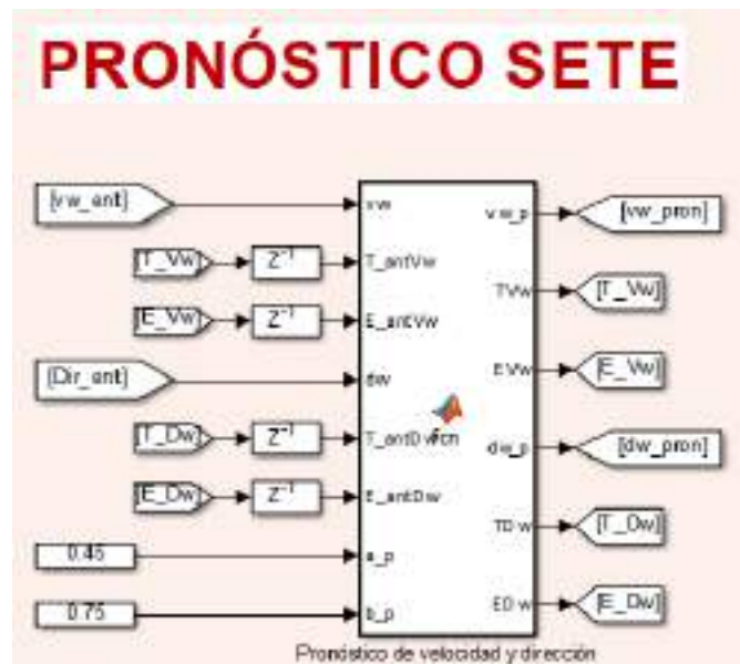
Figura 22. Bloque en Simulink para el pronóstico de las series de tiempo de velocidad y dirección del viento.
