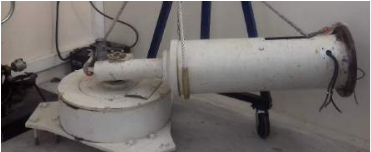
Figura 35. Aerogenerador de 10 kW utilizado para realizar la caracterización eléctrica.
