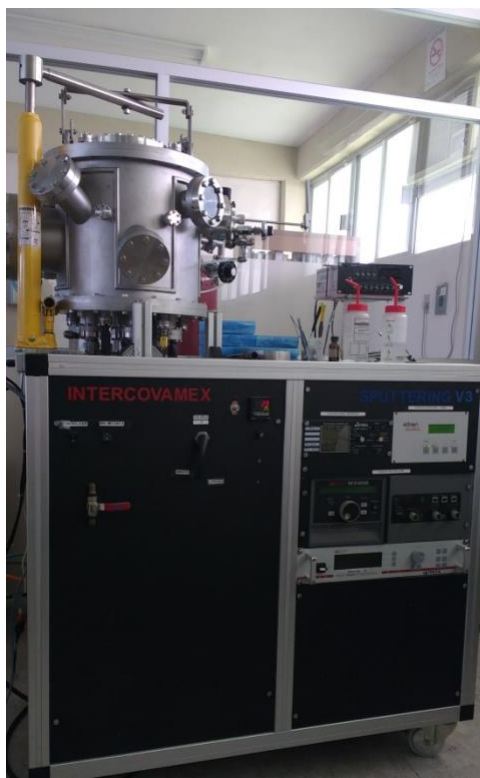
Figura 4-3 Sistema INTERCOVAMEX-V3 sputtering con un Lesker's Torus magnetron gun conectado a una fuente de RF de 600 W.
