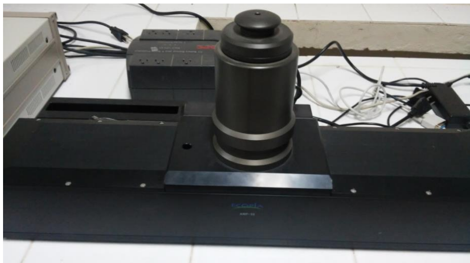
Figura 4-5 Sistema de Efecto Hall Ecopia HMS-5000 Van der Pauw.
