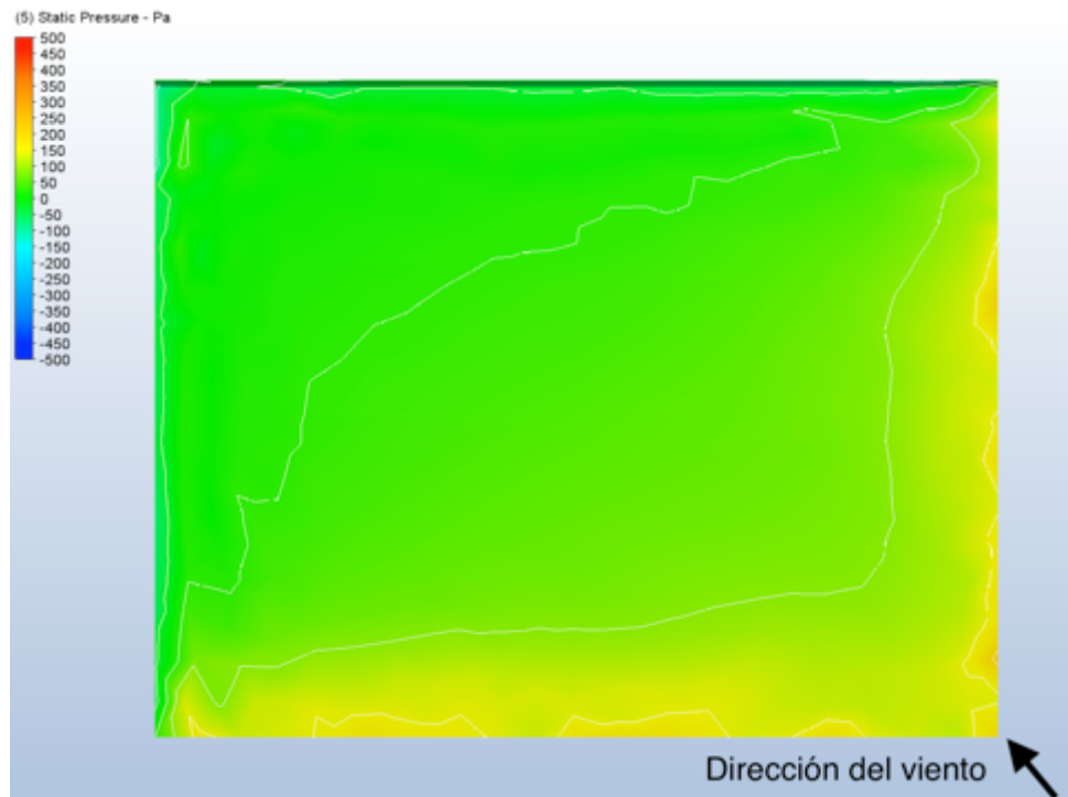
Figura 31. Presión medida en la superficie de los paneles para dirección de flujo 45^\circ (vista frontal).
