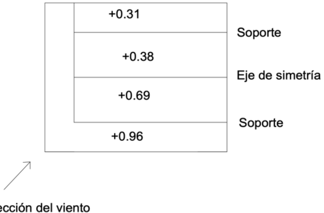
Figura 46. Coeficientes sugeridos para la parte superior del panel solar para una dirección de viento de 45^\circ (Vista frontal).
