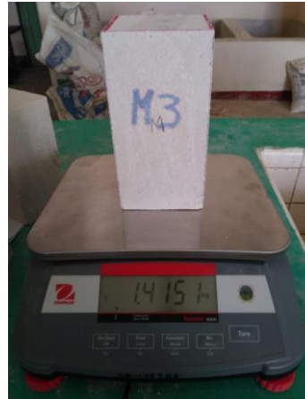
Figura 3.10 Determinación del peso húmedo del espécimen
