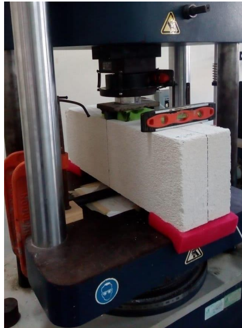
Figura 3.7 Ensayo a tensión de bloques de CCA
