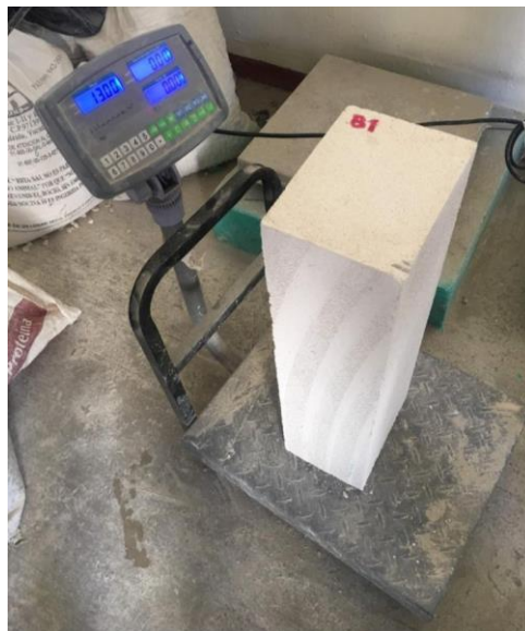
Figura 3.6 Determinación del contenido de humedad de la pieza
