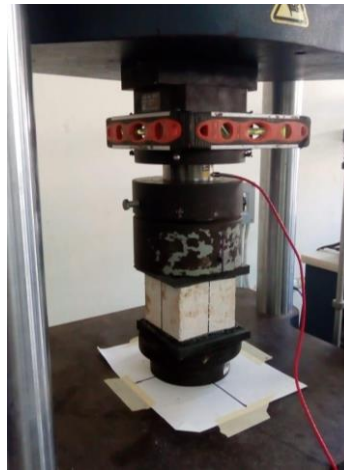
Figura 3.4 Aplicación de la carga a compresión
