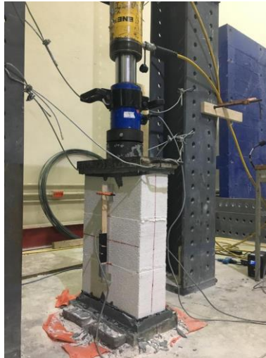
Figura 3.13 Sistema de instrumentación del ensaye a compresión axial de las pilas de mampostería
