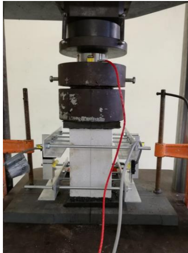
Figura 3.11 Sistema para el ensaye de módulo de elasticidad
