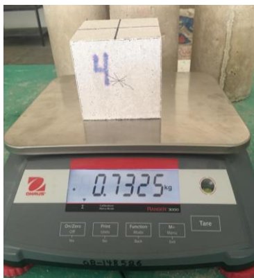
Figura 3.2 Determinación del peso húmedo
