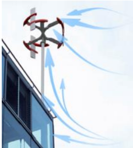
Figura 13. Aerogenerador de eje transversal en edificio (Chong et al., 2017).
