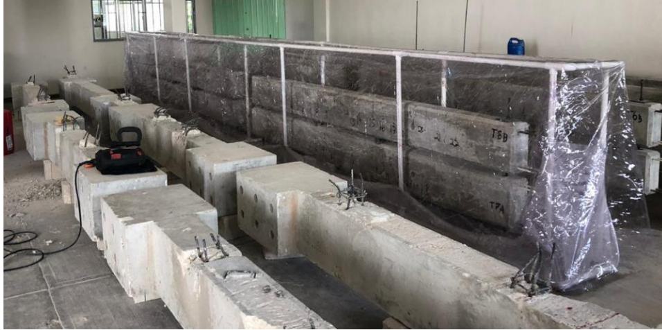
Figura 4.4.- Cámara de corrosión.
