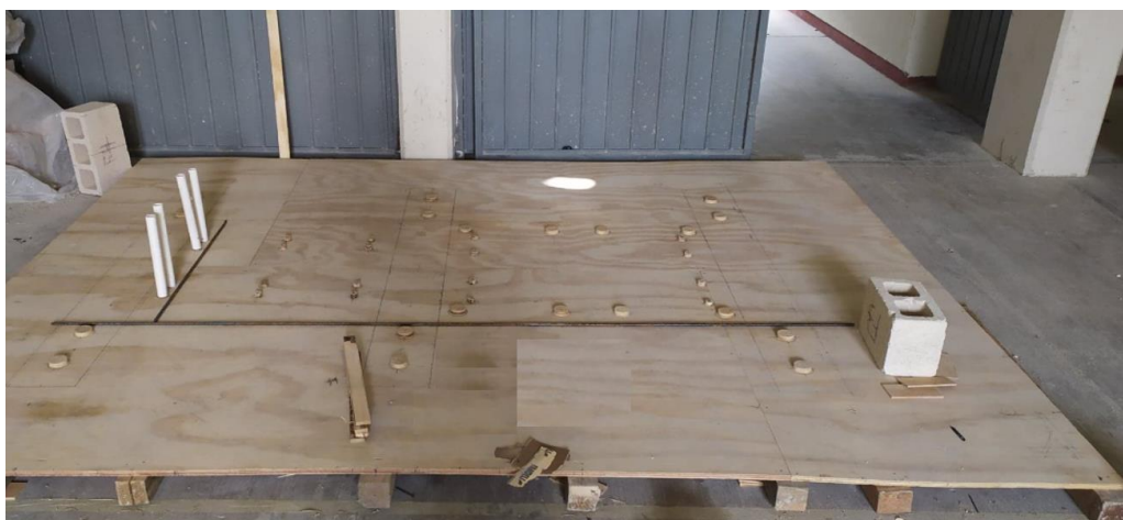
Figura 3.10 Tarima para losa de reacción móvil.
