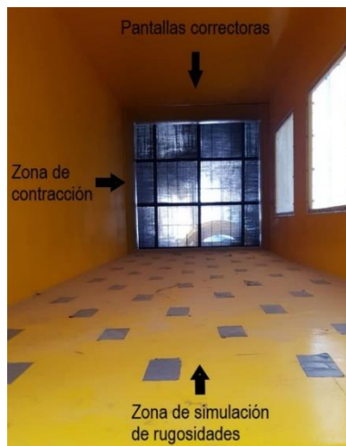
Figura A 8 Zona de simulación de rugosidades.
