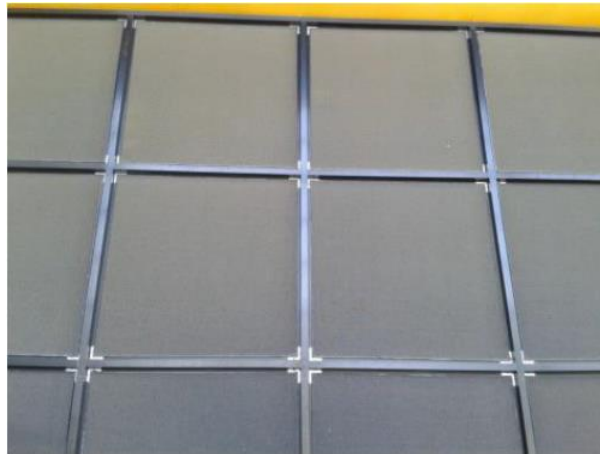
Figura A 6 Zona de rectificación y pantallas correctoras de flujo.
