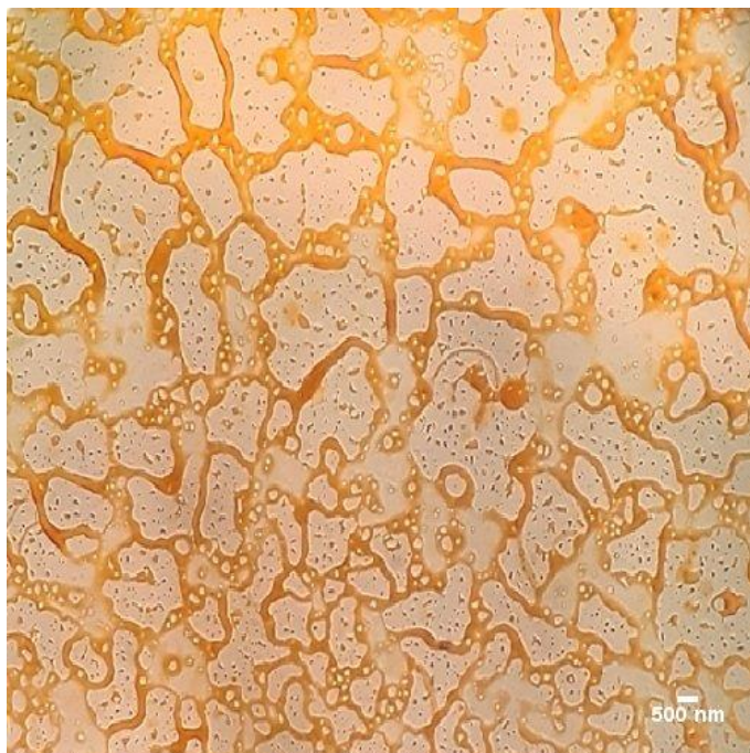
Figura 21 Imagen de microscopía óptica de las películas de P3HTnc preparadas a partir de 5% de PS.
