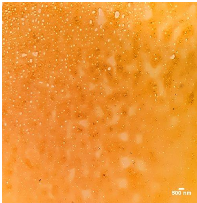
Figura 23 Imagen de microscopía óptica de las películas de P3HTnc preparadas a partir de 1% PS.
