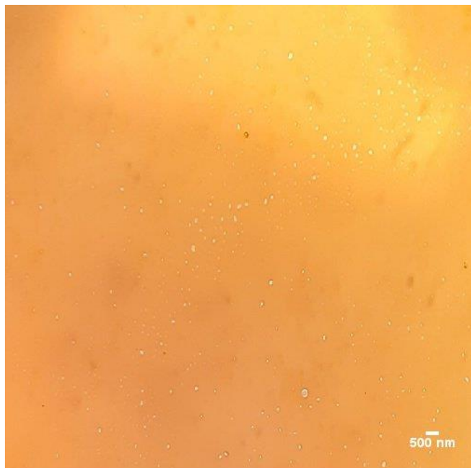
Figura 19 Imagen de microscopía óptica de la película de P3HTnc, preparada a partir de 15% de PS.
