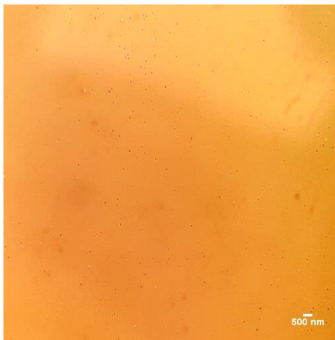
Figura 18 Imagen de microscopía óptica de la película de 15% PS:P3HT.
