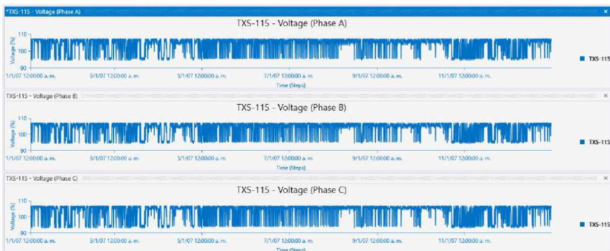
Figura 4.11. Comportamiento del voltaje del nodo TXS-115 (Temax II)
