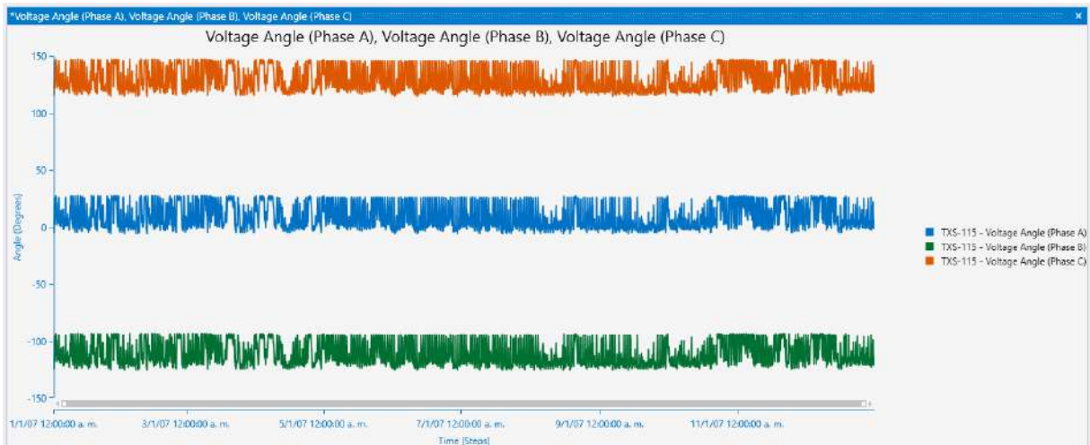
Figura 4.12. Comportamiento de ángulo de voltaje en cada fase del nodo TXS-115 (Temax II)
