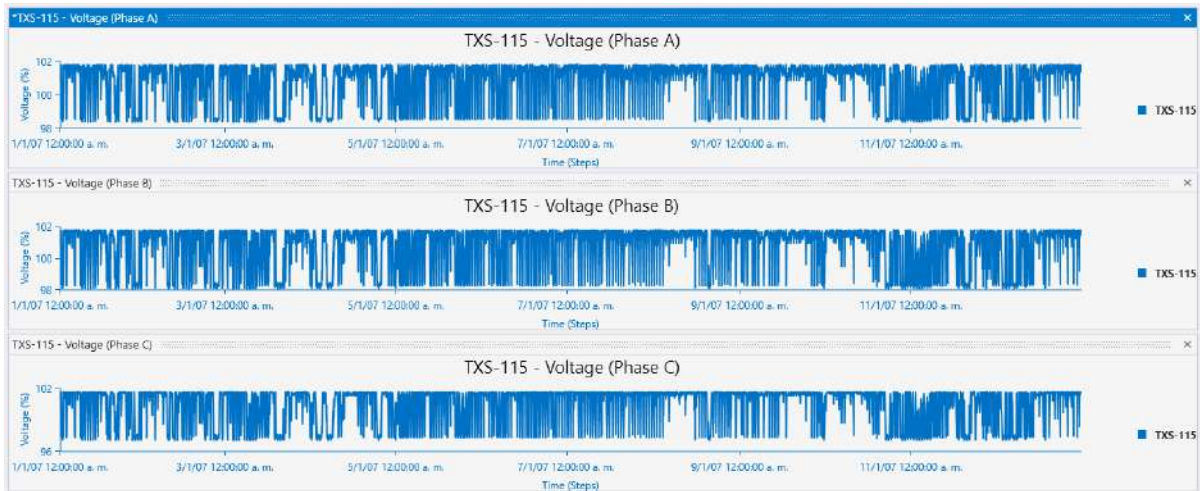
Figura 4.17. Comportamiento del voltaje del nodo TXS-115 (Temax II) con SVC
