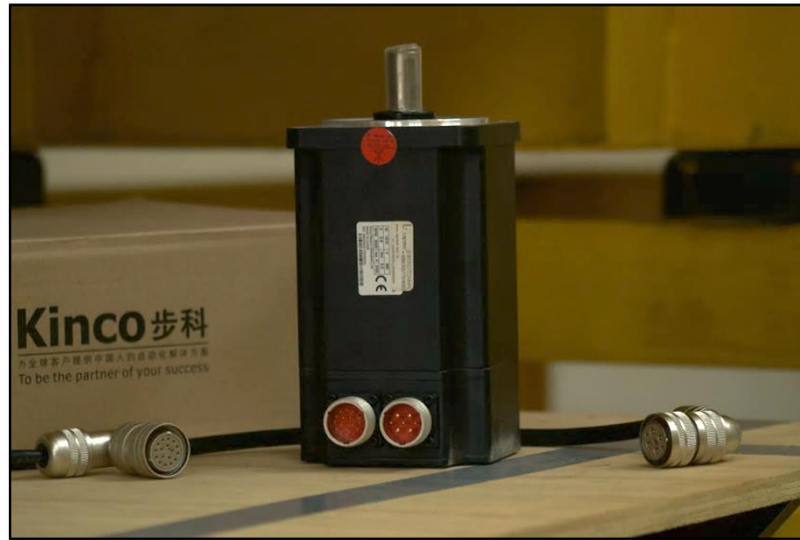
FIGURA 2.22 Servomotor marca Kinco, se observan en la parte inferior las dos terminales de conexión.
