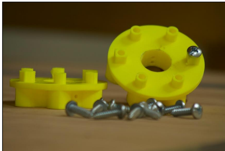
FIGURA 2.9 Adaptador de tracción, presenta aerodinamismo, solidez y robustez optimizando el material.
