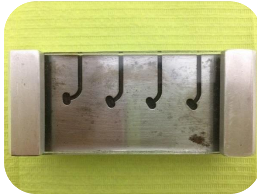
Figura 19. Dispositivo de metal con cuatro conductos simulados de 45, 30, 22.5 y 15° de ángulo de curvatura.
