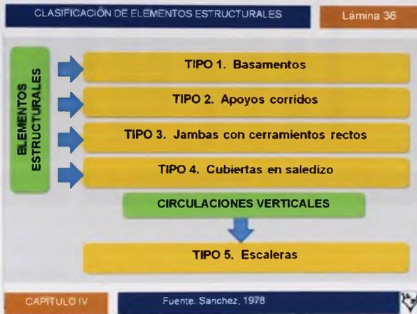
Cada solución estructural presenta variantes por la disposición y trabajo de los elementos estructurales que las componen, así como por la adición de otros elementos complementarios a estos (Ordaz, 2004: 248-466).
