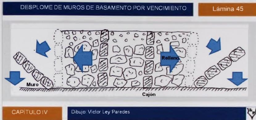
Otra de las causas que intervienen en el colapso de los muros, son las lluvias, que por medio de filtración comienza a humedecer y dañar los materiales.
