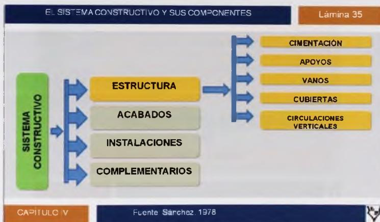
El sistema constructivo de un edificio maya está compuesto con base a la teoría de sistemas de los elementos como la estructura, acabados e instalaciones y complementarios, mismos que se subdividen en cimentaciones, apoyos, vanos, cerramientos, cubiertas y circulaciones verticales. (Véase lámina 35).
