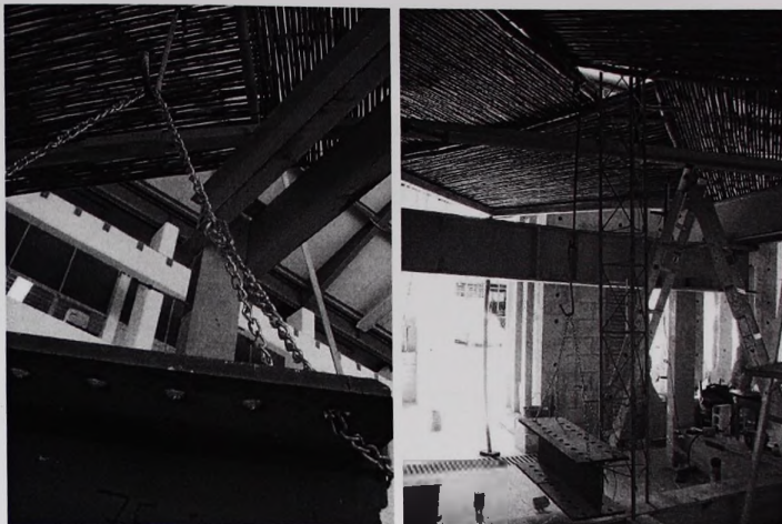
Imagen 3.15 Cargas preliminares aplicadas en W1 y W2
