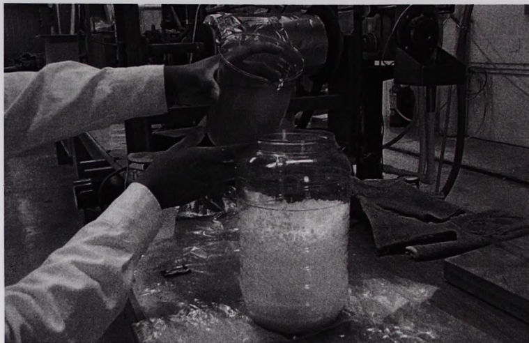
Imagen A2.6 Preparación del barniz de EPS reciclado
