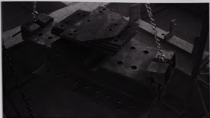
Imagen 3.8 Carga aplicada en W1 Fotografía: Carlos Uribe
