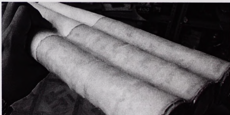
Imagen A2.1 Membrana de textil con barniz de EPS aplicada sobre bambú
