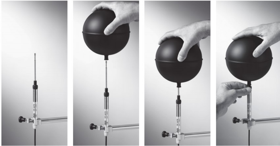
Imagen 3. Sonda termómetro de globo. Fuente: Delta Ohm Manual de instrucciones.
