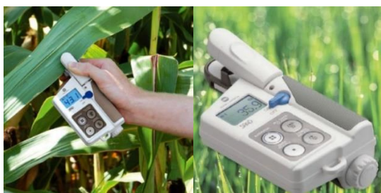
Figura 3. Equipo SPAD-501 de Minolta®, utilizado para la estimación del contenido de clorofila y nitrógeno total en plantas de interés comercial. Spectrum Tecnologías, Inc. (2019)
