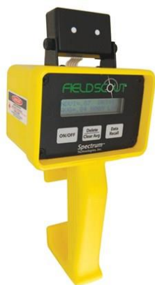
Figura 4. FieldScout CM 1,000 NDVI de Spectrum Technology ® , para la estimación de propiedades químicas en plantas. Spectrum Tecnoligies, Inc.2. (2019).{ }
