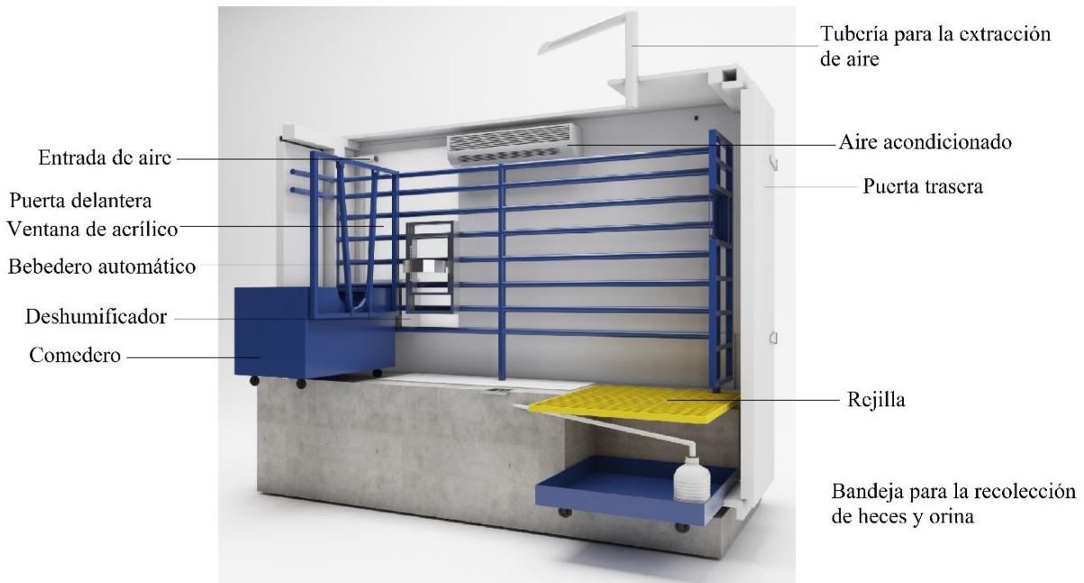
Figura 4. Cámara de respiración de circuito abierto, sección lateral.
