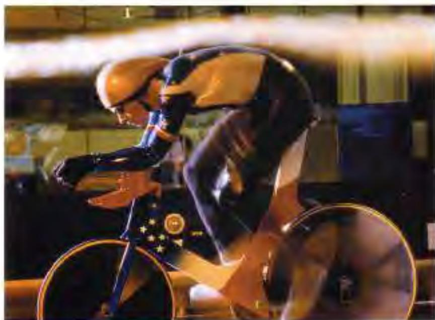
Este ciclista olímpico monta una bicicleta estacionaria en un túnel de viento. Observando el flujo de aire en torno a su cuerpo (con la ayuda de estelas de humo), los científicos pueden determinar qué diseños de bicicleta y técnicas de ciclismo reducen al mínimo la resistencia del aire y aumentan al máximo el desempeño.
