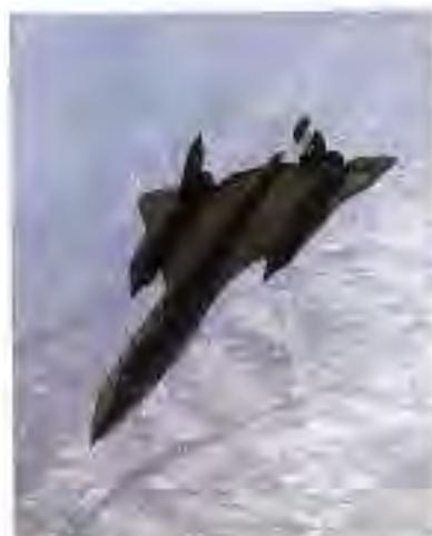
**17.10** Cuando este avión SR-71 está en tierra, los paneles de sus alas carbonan de forma tan holgada que hay fugas de combustible de las alas al suelo. Sin embargo, una vez que el avión está en vuelo a más del triple de la rapidez del sonido, la fricción del aire calienta tanto los paneles que se expanden para embonar perfectamente. (El abastecimiento de combustible durante el vuelo compensa la pérdida de combustible en tierra.)
