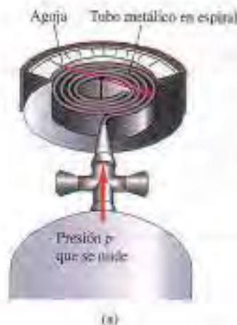
**14.9** (a) Medidor de presión de Bourdon. Al aumentar la presión dentro del tubo espiral metálico, éste se endereza y desvía la aguja unida a él. (b) Medidor de presión tipo Bourdon empleado en un tanque de gas comprimido.
