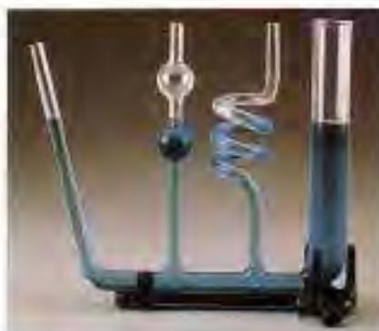
14.6 La presión en la parte superior de cada columna de fluido es igual a  $p_0$ , la presión atmosférica. La presión sólo depende de la altura, no de la forma del recipiente, así que todas las columnas de fluido tienen la misma altura.
