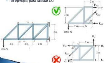
**Método de las Secciones**
