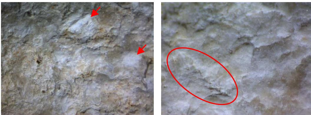
**Nota.** Izquierda (a): cara anversa. Triturados (8x). Derecha (b): cara anversa. Agregados de granos/fosillas (30x).
